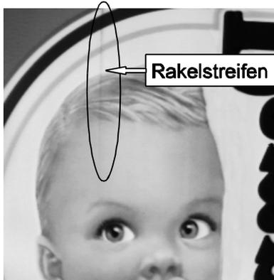
Bild 19 Rakelstreifenfehler
